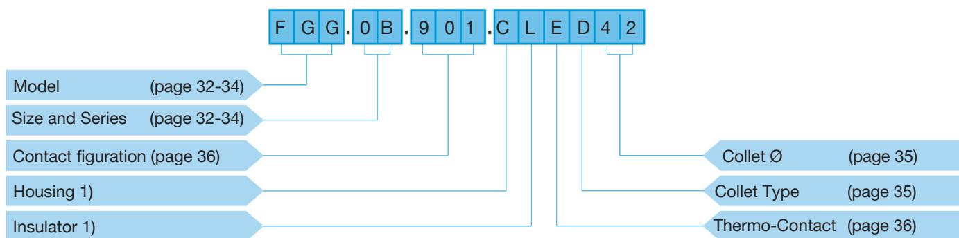
Stecker gerade mit Führungsstange (G), Serie B, Größe 0, 2 Kontakte, Außenkörper aus verchromtem Messing Isolationsteil aus PEEK. Thermokontakt Typ E, Spannzange Typ D für Kabeldurchmesser 4.2 mm.
