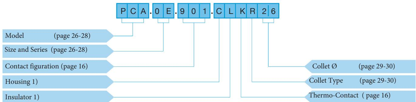
Kabelkupplung, Serie E, Größe 0, mehrpolig mit 2 Kontakten Außenkörper aus verchromtem Messing, Isolationsteil aus PEEK, männlicher und weiblicher Lötkontakt, Thermo-Spannzange Typ R26
