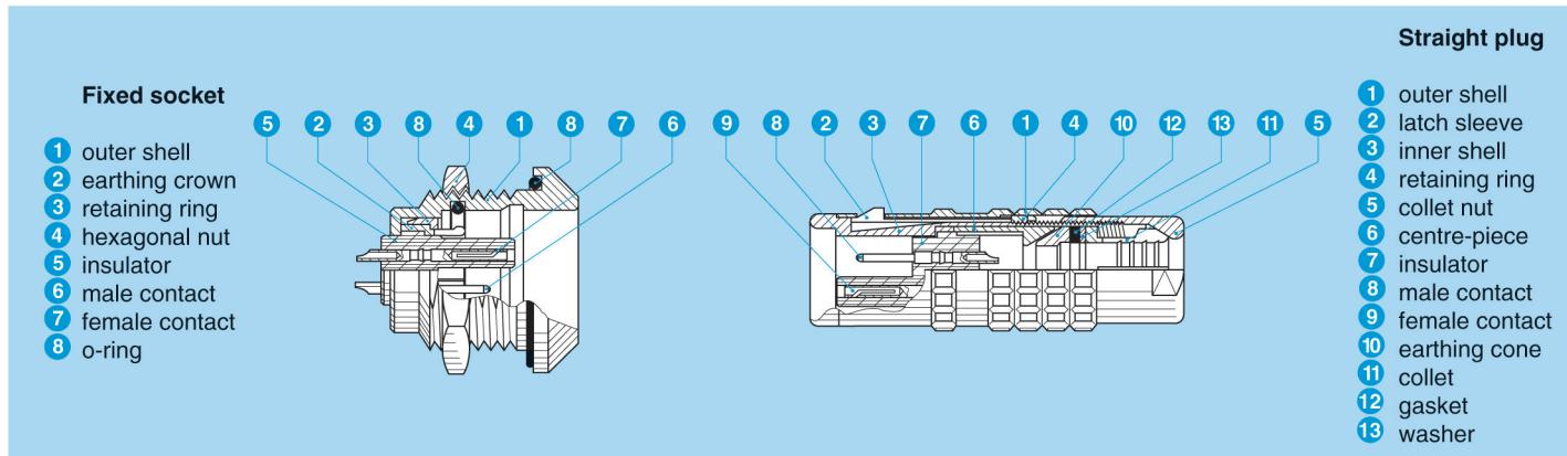
Kabelkupplung wasserdicht | Free socket watertight
