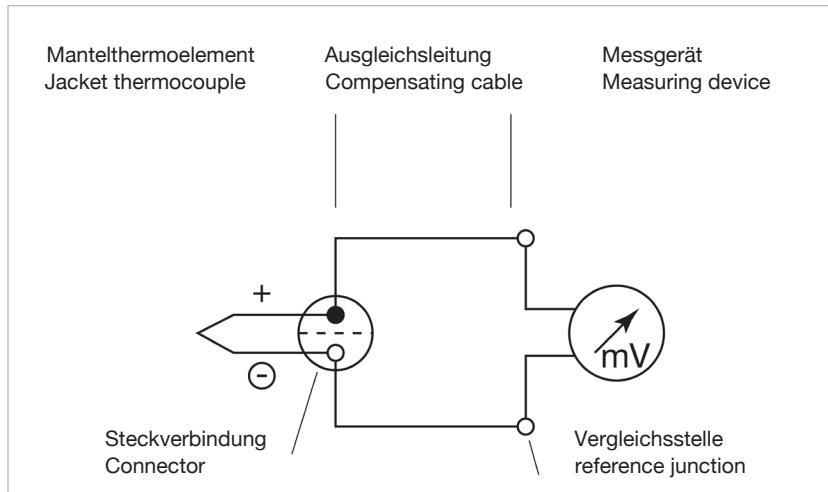
Um eine einwandfreie Funktion der Miniatur-Mantel-Thermoelemente zu gewährleisten, müssen die Anschlußstellen gegen Feuchtigkeit dicht abgeschlossen werden. Dies geschieht durch Vergießen mit Epoxidharz.
