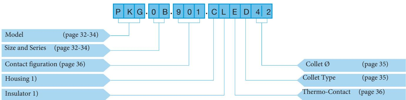
Einbauapparatedose mit Führungsstange (G) und Zugentlastung, Serie B, Größe 0, mehrpolig (2 Kontakte), Außenkörper aus verchromten Messing Massekrone vernickelt, Isolationsteil aus PEEK, Thermokontakt Typ E, Spannzange Typ D für Kabeldurchmesser 4.2 mm.
