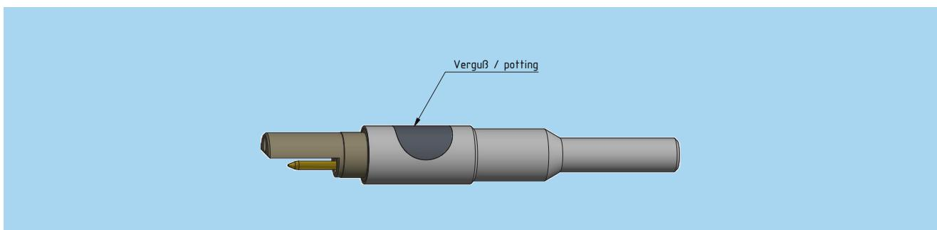
Aus langen Erfahrungswerten geht hervor, daß bei den gebräuchlichsten Thermopaaren, wie z. B. NiCr-Ni die hochwertigen LEMO-Kontakte in der vergoldeten Version eingesetzt werden können. An der Anschlußstelle mit dem Thermoelementmaterial heben sich die Thermospannungen nahezu auf.
