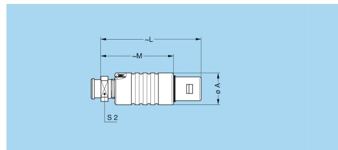
**FFE** Stecker, gerade, Spannzange, vorderseitiger Dichtung und Schraube für Knickschutztüle 1) (Schutzart IP54, im gesteckten Zustand)
