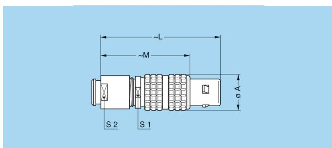
**FGZ** Gerader Stecker, Spannzange und Spannschraube für Knickschutztüle 1)
