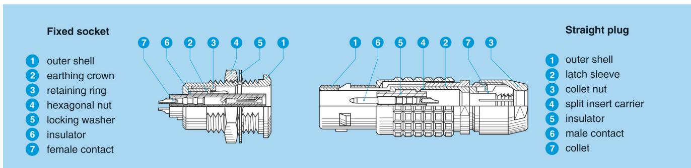
Stecker gerade mit Führungsstange (G) | Straight plug with key (G)
